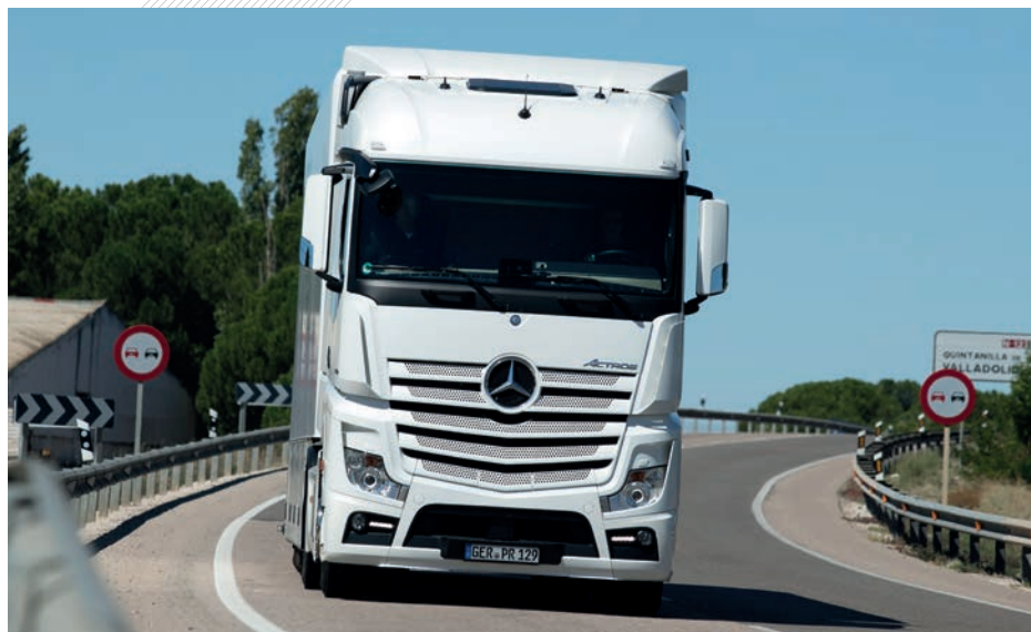
Las cabinas StreamSpace de 2,5 metros de ancho son 15 kg más ligeras que las BigSpace y pesan 20 kg menos que las GigaSpace.
