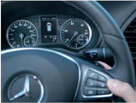
El cambio automático 7G-Tronic Plus incluye levas en el volante, de manera que podemos subir y bajar marchas como si de un deportivo se tratase.
