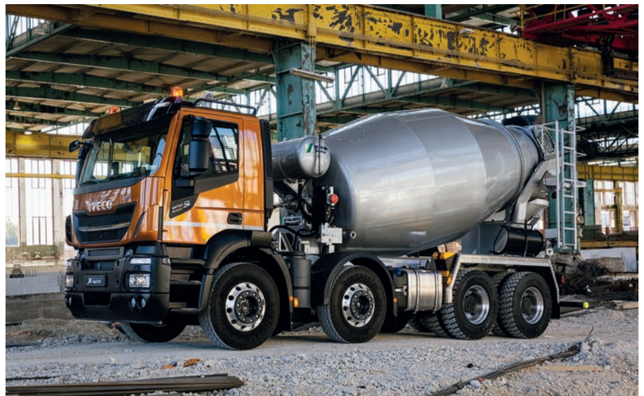
La nueva gama se ofrece con dos, tres y cuatro ejes, incluyendo la combinación 8x4 trídrem para hormigoneras.
