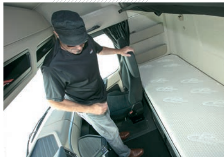
El asiento tipo transportín del acompañante facilita la vida del conductor solitario, pero resulta incómodo -dado que carece de suspensión- cuando se trabaja en modo: doble tripulación.
