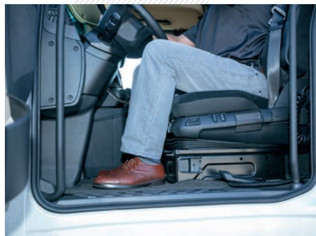
Las cabinas StreamSpace de 2,3 metros de ancho se ofrecen en dos versiones: con túnel motor de 170 mm de alto o sin túnel motor. Las StreamSpace de 2,5 metros de ancho siempre disfrutan de piso plano.
