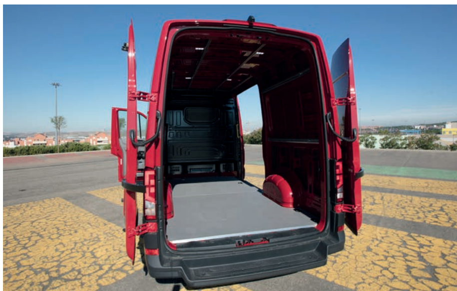
El Crafter que teníamos entre manos ofrecía un volumen interno de 11,3 m 3 , si bien, dependiendo de las medidas, puede superar los 18 m 3 .
