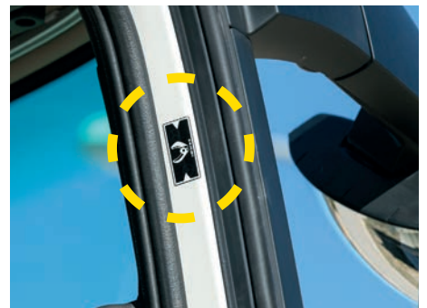
Mercedes-Benz apuesta siempre por la seguridad. Estos puntos marcados en el vano de las puertas indican a los bomberos el lugar idóneo para realizar un corte en la cabina en caso de descarceración.
