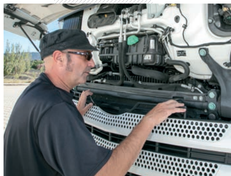
Los nuevos Actros no llevan sirga para medir el nivel de aceite. El conductor únicamente puede comprobar el nivel del lubricante a través del ordenador de a bordo.
