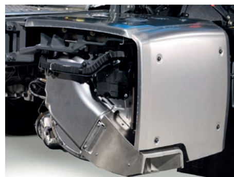
El sistema de postratamiento de los gases de escape ha reducido sus dimensiones en un 40% y ha perdido 50 kg de peso.
