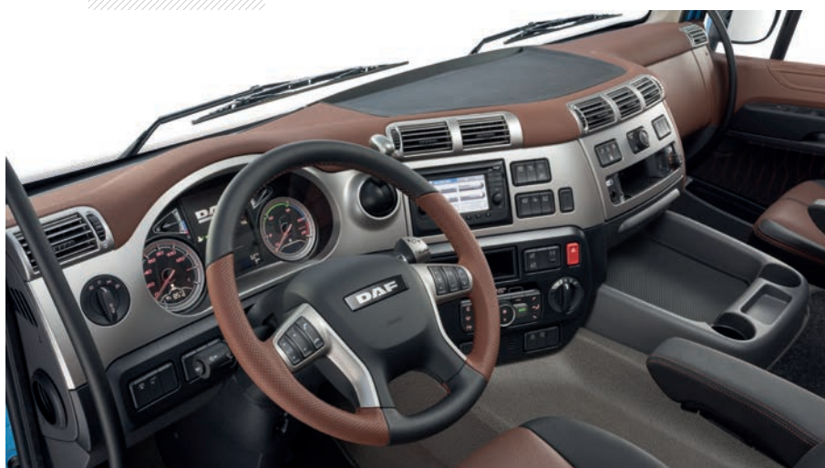
DAF utiliza un acabado interior similar en todos sus vehículos. El cuentarrevoluciones nos indica que estamos trabajando sobre un nuevo DAF euro6 C, ya que ahora su zona económica comienza por debajo de las 900 rpm.
