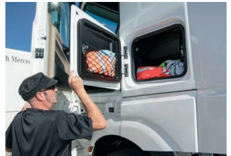
No es posible abrir las dos compuertas laterales al unísono. La situada en la parte superior se abre hacia la izquierda, mientras que la inferior lo hace hacia arriba.
