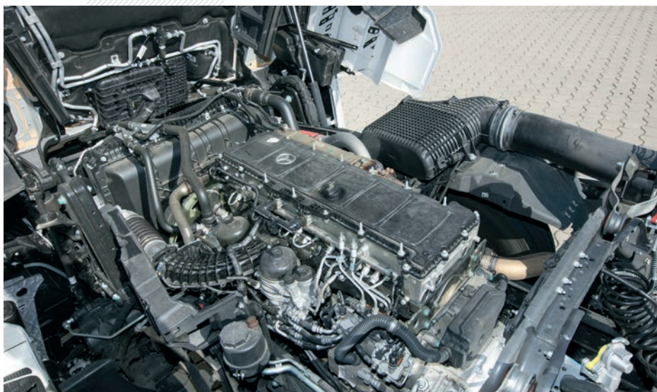
A partir de 2015 los nuevos Actros euro6 C consumen casi un 9% menos de combustible. Sus motorizaciones se han visto aumentadas. Las nuevas versiones son: para los motores de 10,7 litros 455 CV, para los de 13 litros 530 CV y para los de 15,6 litros 625 CV.
